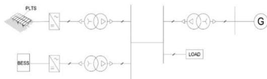
Fig. 1. A configuration of hybrid diesel-PV-BESS
